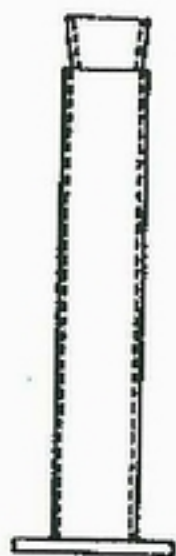
圖一：以共栓量筒分析混合農藥之乳化性及起泡性。
